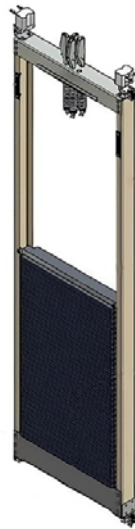
شکل ۶-۱۱- نمونه‌ای از قاب و وزنه تعادل
