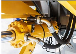
شکل ۷-۳- نمونه ای از شیلنگ‌های انتقال روغن هیدرولیک
