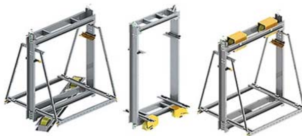
شکل ۶-۱۳- نمونه‌ای از قاب نگهدارنده کابین
