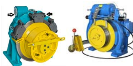
شکل ۶-۶- نمونه‌ای از ترمز الکترومغناطیسی الکتروموتور محرک
