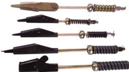
شکل ۸-۴- نمونه ای از انواع قلاب‌های سرسیم بکسل‌ها
