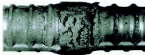
شکل ۳-۷: نمونه‌ای از نواقص مشاهده شده ناشی از حرارت بیش از حد ۱ حین جوشکاری بر روی سطح جوش پس از هات پانچ (Yamamoto et al. , 2002)
