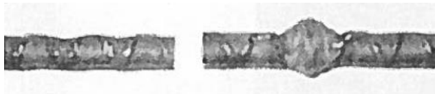
شکل ۲-۱۶: شکست ترد به دلیل صدمه ناشی از پیچ‌های گیره مورد استفاده در جوش فورجینگ (JRJI, 2009)
