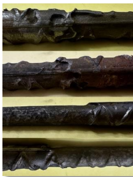
شکل ۳-۳۲: بررسی رفتار میلگردهای دارای وصله جوشی GPW در معرض خوردگی (خالصی و خیرالدین، ۱۴۰۲)
