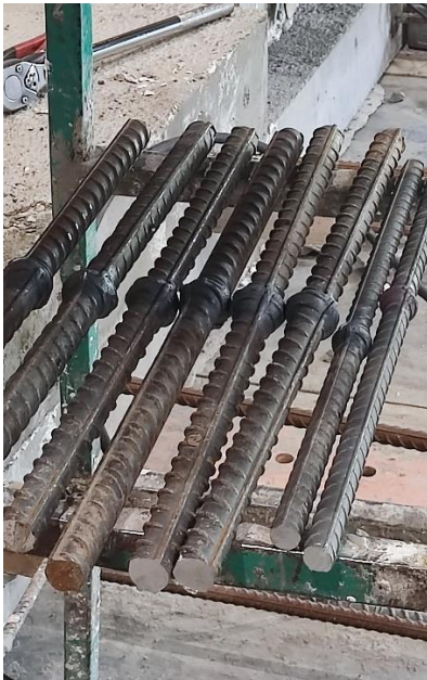
شکل ۴-۱: ساخت نمونه‌های وصله جوش فورجینگ در آزمایشگاه و برخی از نمونه‌های ساخته شده
