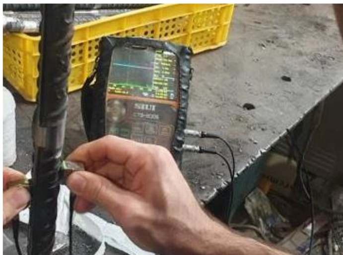
شکل ۴-۲: آزمون التراسونیک یکی از نمونه‌های وصله شده با جوش فورجینگ
