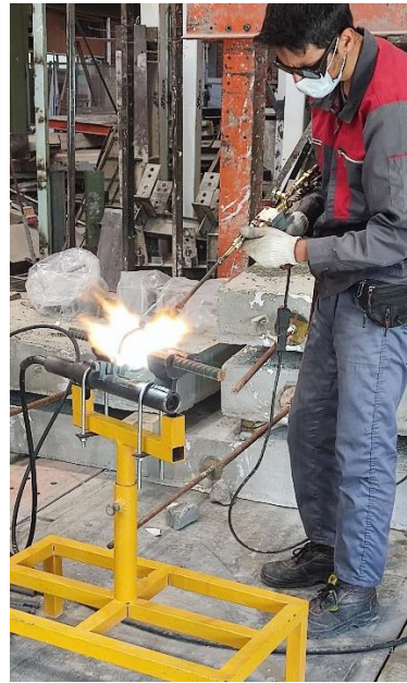
شکل ۴-۱: ساخت نمونه‌های وصله جوش فورجینگ در آزمایشگاه و برخی از نمونه‌های ساخته شده
