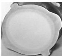
شکل ۳-۲۷: مقطع میلگرد ترمکس، لایه مارتنزیت خارجی در کنار لایه بینیت میانی و هسته فریت و پرلیت (Moustafa et al. , 2016)
