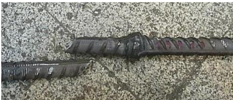
شکل ۴-۳: یکی از نمونه‌های با قطر ۲۵ میلیمتر پس از آزمون کشش
