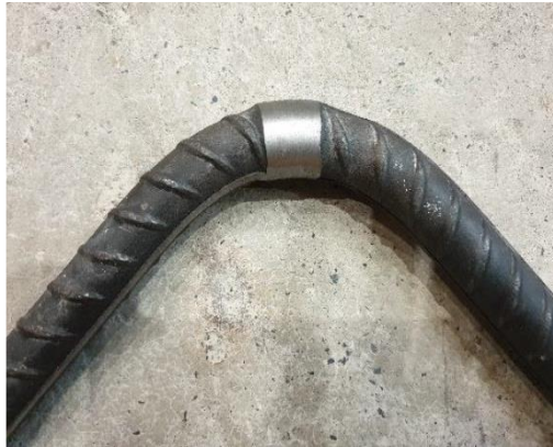
شکل ۴-۳: یکی از نمونه‌های با قطر ۲۵ میلیمتر پس از آزمون خمش
