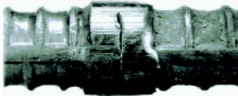
شکل ۳-۶: نمونه‌ای از ترک مشاهده شده روی سطح جوش پس از هات پانچ (Yamamoto et al. , 2002)
