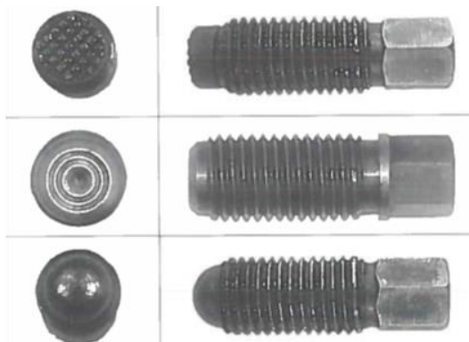
شکل ۲-۳: نمونه‌هایی از سر پیچ‌های قابل استفاده برای نگهداری میلگرد در حین فورجینگ
