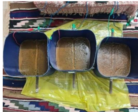
شکل ۳-۳۲: بررسی رفتار میلگردهای دارای وصله جوشی GPW در معرض خوردگی (خالصی و خیرالدین، ۱۴۰۲)
