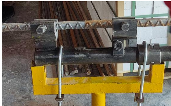
شکل ۲-۸: نحوه بستن میلگردها به گیره در جوشکاری فورجینگ
