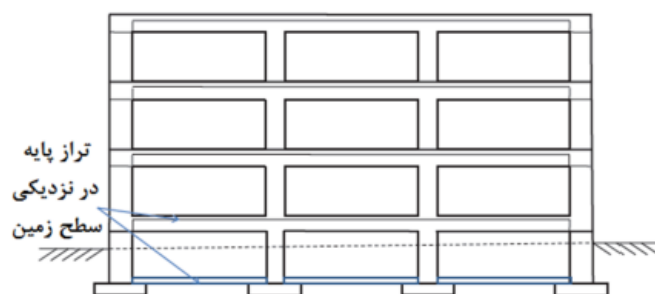
شکل ۳: تراز پایه در بالای سطح زمین [۱].
