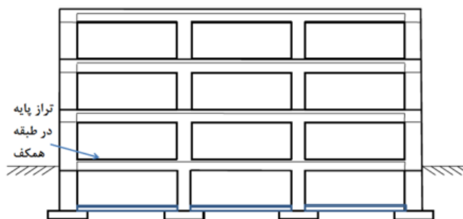
شکل ۲: تراز پایه در ساختمان‌های دارای زیرزمین [۱].
