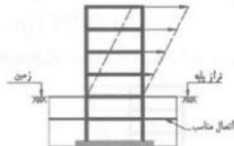
اتصالات مناسب در اطراف ساختمان مانع تغییر شکل
