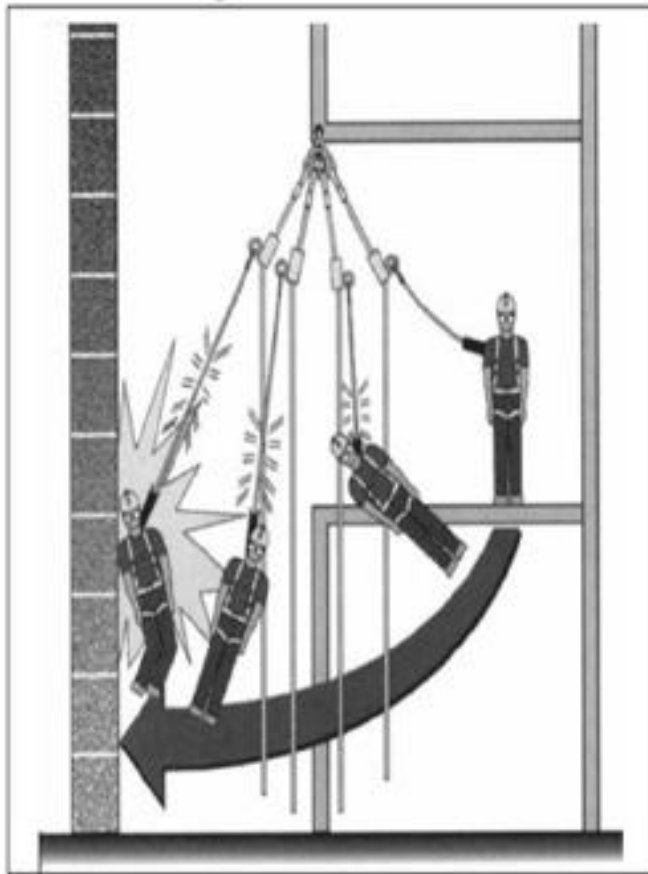
خطر اثر آونگی هنگام سقوط از ارتفاع
