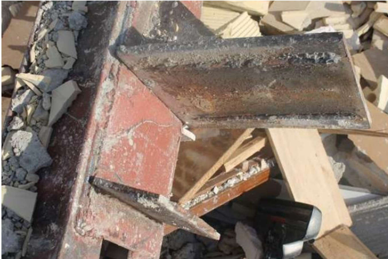
عملکرد نامناسب اتصال گیردار
