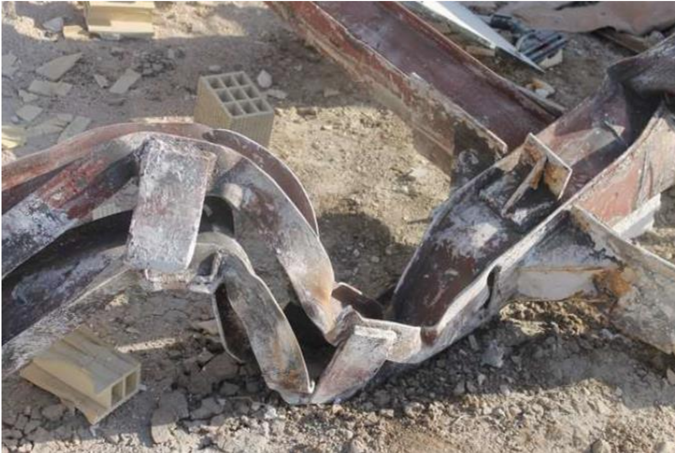
عملکرد نامناسب ستون دارای بست افقی (پا باز) در قاب خمشی
