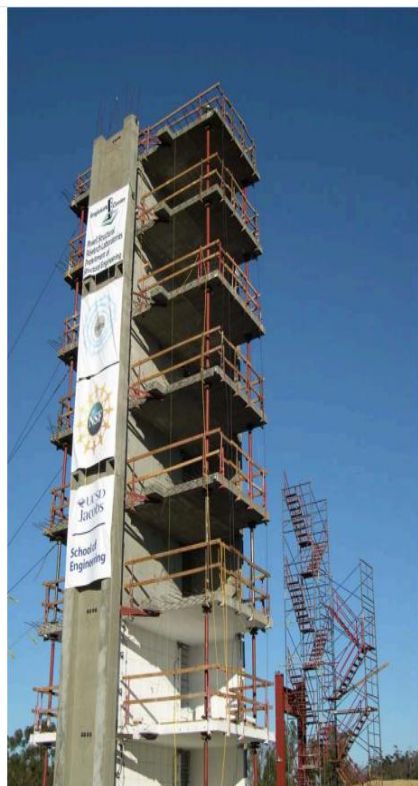
شکل ۱-۳- سازه‌ی دیوار برشی ۷ طبقه‌ی آزمایش‌شده در روی میز لرزه‌ی سرباز دانشگاه سن دیگو.
