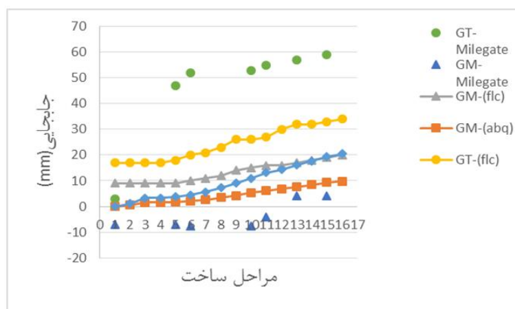
شکل ۸-۴ جابجایی در لایه‌های ژئوممبرین و ژئوتکستایل در ارتفاع ۲۴/۶ متر از زیر تاج لندفیل
