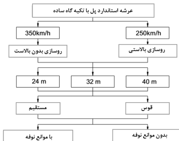
شکل ۲-۷: دسته‌بندی تیر با تکیه‌گاه ساده در پل‌های خطوط سریع‌السییر [۲۴].
