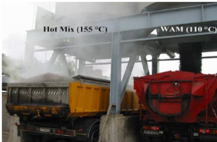
شکل ۱: کاهش میزان بخارات و گازهای متصاعد شده در فرآیند ساخت مخلوط نیمه گرم در مقایسه با مخلوط گرم
