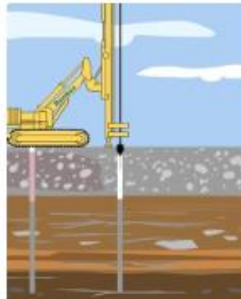
د- نصب مسدود کننده سر گمانه
