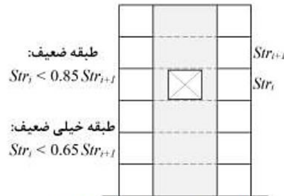
ت - نامنظمی مقاومت جانبی عناصر قائم مقاوم لرزه‌ای
